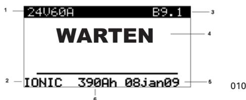
Auf dem Display werden Informationen über die angeschlossene Batterie angezeigt, und die verbleibende Zeit bis zum Beginn der effektiven Ladung wird rückwärts gezählt.
